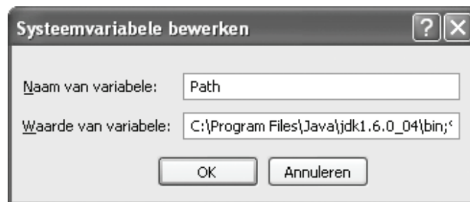
FIGUUR 6 Voeg <waarde van JAVA_HOME>\bin; toe aan variabele Path (wat er al stond, blijft staan)
